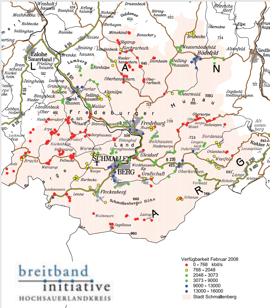
Detaillierte Darstellung der verfügbaren Bandbreiten an DSL-Anschlüssen im Stadtgebiet Schmallenberg.
